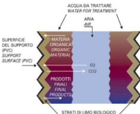
VISTA SCHEMATICA IN SEZIONE DEL LIMO BIOLOGICO IN UN FILTRO A PERCOLAZIONE SCHEMATIC DRAWING IN SECTION OF THE BIOLOGICAL SLIME IN A TRICKLING FILTER
